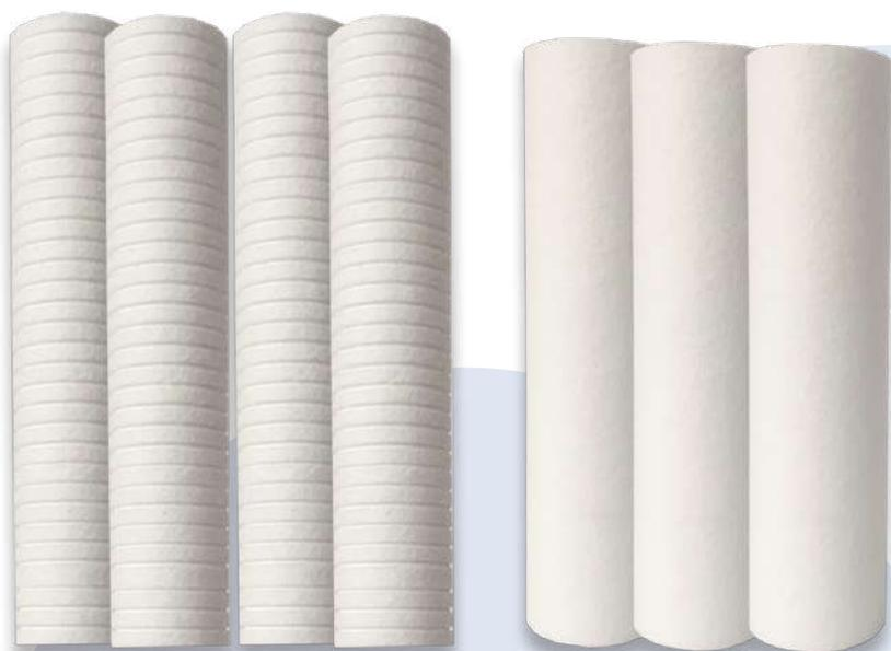
Os elementos de polipropileno expandido são fabricados em uma matriz de densidade graduada de fibras de polipropileno uniformes, fornecendo uma filtragem consistente para uma grande variedade de fluidos. Elemento disponível de 1 a 100 micra e até 40" de altura. São comumente indicados para retenção de partículas sólidas presentes no fluido que está sendo filtrado.
