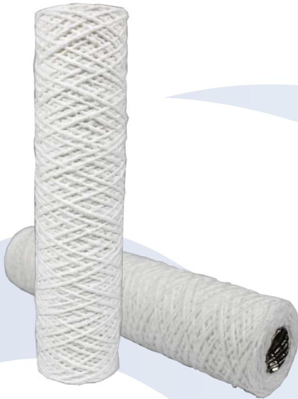
O Cartucho bobinado é indicado para retenção de partículas sólidas presente no fluido que está sendo filtrado. São fabricados com fio de polipropileno ou algodão e com núcleo de polipropileno ou aço inox. Essa possibilidade de construção proporciona compatibilidade química e suporta temperaturas elevadas quando comparado com outros cartuchos.
